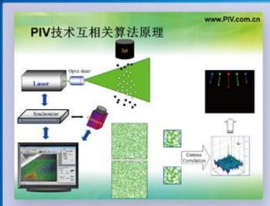
PIV系统通过在流场中布撒大量示踪粒子（小于10微米）跟随流场运动（空气中使用空心玻璃微珠或者液体小颗粒烟雾，水中使用密度接近水的空心玻璃微珠），把激光束经过组合透镜扩束成片光照明流场，使用数字相机拍摄流场照片，得到的前后两帧粒子图像，对图像中的粒子图像进行互相关计算得到流场一个切面内定量的速度分布。进一步处理可得流场涡量、流线以及等速度线等流场特性参数分布。
